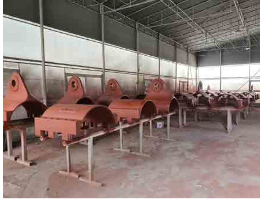
Proje için özel olarak üretilen kablo kelepçeleri. The cable clamps produced specifically for the Project.
